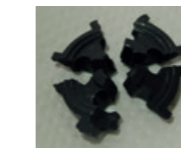
Monroe-Bodenventil: Bruch nach allen Versuchen.
